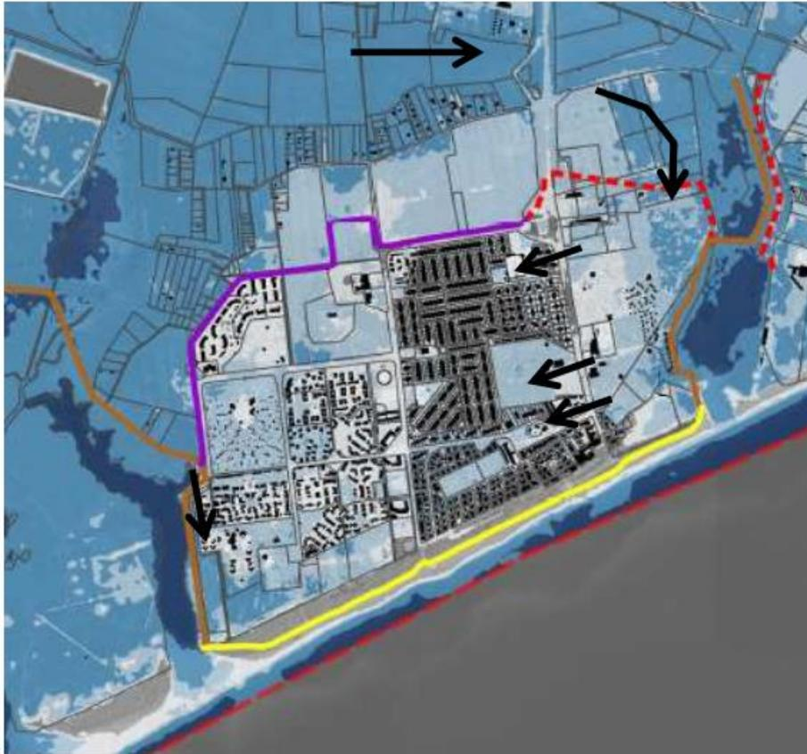
Figure 4 : Vue de la simulation hydraulique en situation actuelle pour une période de retour 100 ans
