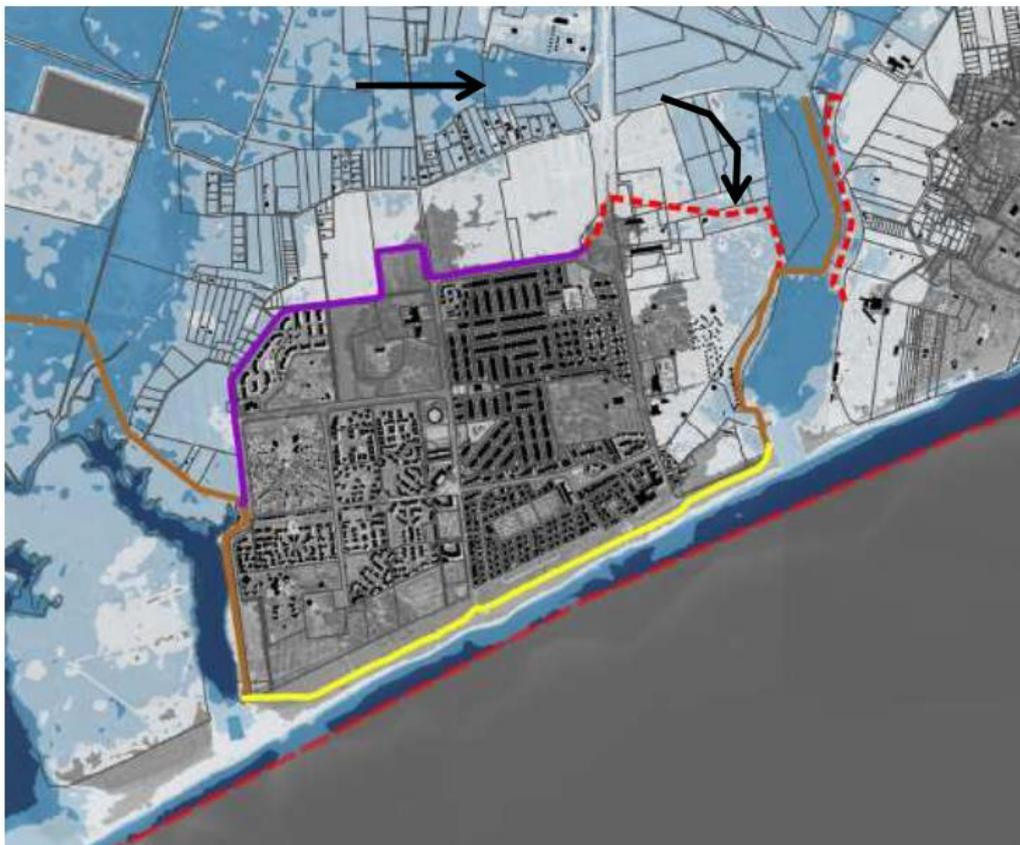
Figure 4 : Vue de la simulation hydraulique en situation actuelle pour une période de retour 10 ans
